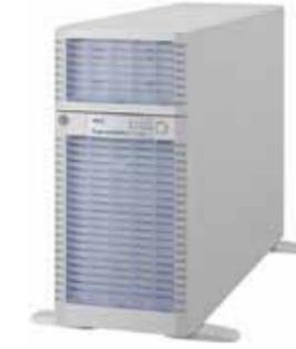
オフィスの節電対策を支援する40℃稼働保証など、コストパフォーマンスとともに現場設置の利便性を追求したタワーサーバです。SATA2ハードディスク3台を搭載し、RAID1+ホットスベアディスク構成としています。
